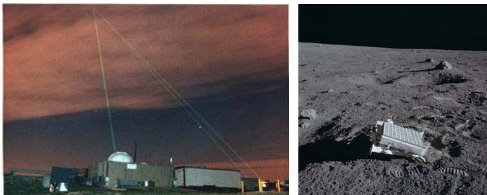
Slika 1-25: Tehnika laserskog mjerenja dužina do Mjeseca: Goddard opservatorija postavljena je na površini Zemlje (GGAO, 2017 a) a reflektore na površini Mjeseca postavile su Apollo misije 11, 12 i 14, (GGAO, 2017 b)
