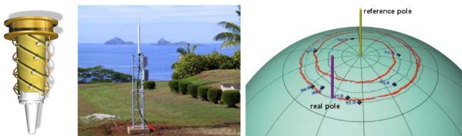
Slika 1-27: Antena DORIS sistema, duga 42 cm, koja se postavlja na LEO satelite, slika lijevo. (DORIS, 2017); Antena prima signale koji emitiraju predajnici na Zemlji, slika u sredini, (eoP, 2017 b); Rezultat opažanja DORIS tehnikom, između ostalog, može biti praćenje pomjeranja pola (slika desno). (Alitimetry, 2017 a)
