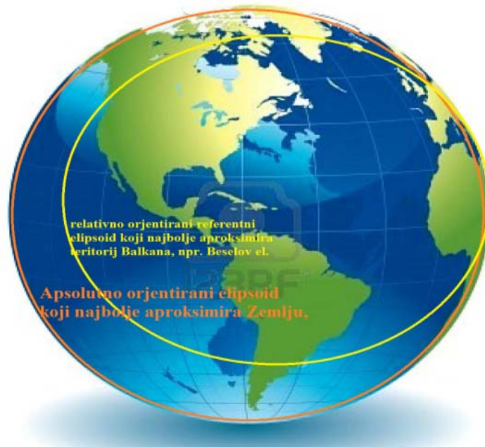
Slika 4-3: Relativno (lokalno) i apsolutno (globalno) orijentiran elipsoid.
