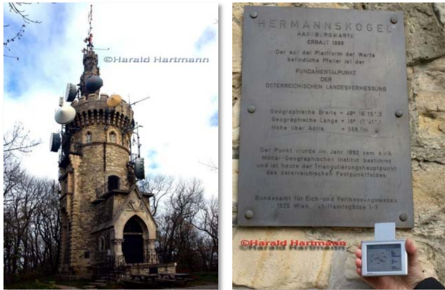
Slika 4-1: Današnji izgled mjesta koje je bilo ishodište Austrougarskog geodetskog datuma Hermannskogel, na brdu kod Beča. Samo tabla s natpisom (slika desno) podsjeća na važnost mjesta. (Sagen, 2012)
