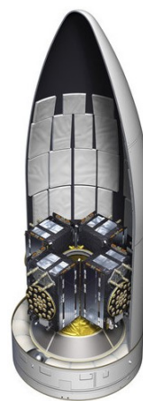
Slika 5.10: Četiri Galileo satelita (23-26) pričvršćena za raketu Ariana 5 i spremljeni za lansiranje izvedeno u julu 2018., lijevo (URL 5.27); Crtež četiri satelita unutar rakete, desno. (URL 5.28)
