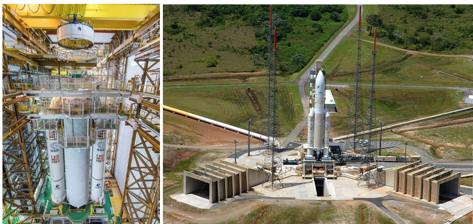
Slika 5.11: Raketa Ariana 5 spuštена da se instaliraju povezana četiri satelita Galileo 2017. godine, lijevo. (URL 5.30). Rakete Ariana 5 na lansirnoj rampi, u ESA bazi za lansiranje u Francuskoj Gvajani, desno. (URL 5.31)
