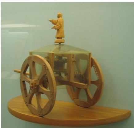
Slika 2.7: Jug pokazujuća kočija, replika. (lijevo). Ruka lutke pokazuje jug bez obzira u kom pravcu se kreće kočija, zahvaljujući sklopu ručno izrađenih diferencijalnih zubčanika pokazanih desno. Značajno je napomenuti da je bilo potrebno poznavati orijentaciju polazišne tačke. URL 2.7 i 2.8.
